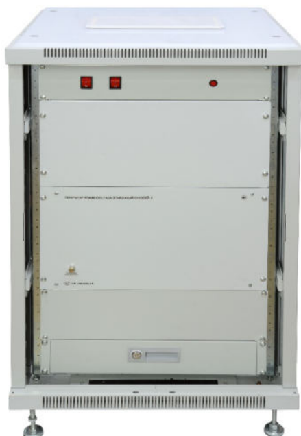
Рисунок 3 – Внешний вид генератора влажного газа эталонного Суховой-4В стоечного исполнения, установленного в 19” стойку с термостатируемой измерительной камерой.
