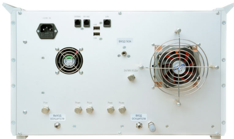
Рисунок 4 – Вид генератора Сухой-4В настольного исполнения сзади.
